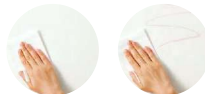
フィルム汚れ防止壁紙 一般ビニル壁紙 [試験方法] 壁紙表面にクレヨンで書き込み、エタノールを用いて拭き取りを行った。
