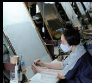
製織された織物壁紙は、繊細な感覚を持つ職人のもとへ。触れた時の摩擦音の違いで糸のほつれに気が付き補修をするなど高い技術力を持つ職人により、目に見えない細部まで美しい良質な壁紙が生み出されています。
