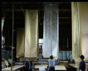
箔と裏紙の密着性を上げるために天井から吊るして、10日ほど自然乾燥をさせます。その後コーティングを複数回行い、時間を掛けて仕上げることで壁紙の強度が増加。長年輝き続ける良質な光沢が生まれます。
